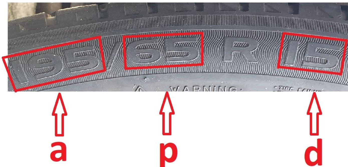
Rysunek 4. Rozmiar opony zamontowanej na feldzie stalowej w pojeździe klienta
