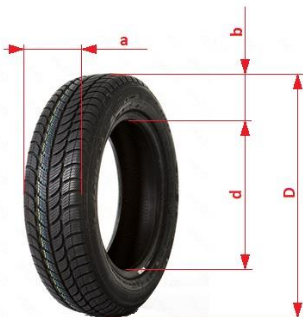
Rysunek 5. Wymiary opony samochodowej
