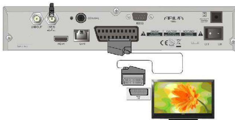
Rysunek 1. Schemat połączenia tunera satelitarnego z OTVC:
