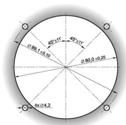
Rys.2 Rysunek otworu montażowego prędkościomierza PR-50-AB
