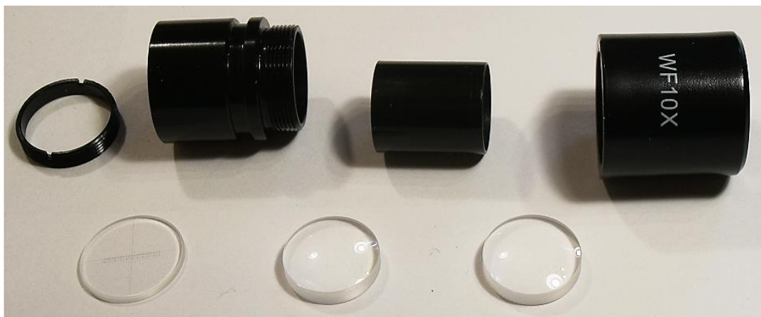
Rysunek 2. Zespół okularu mikroskopowego w rozbiórce na części.
