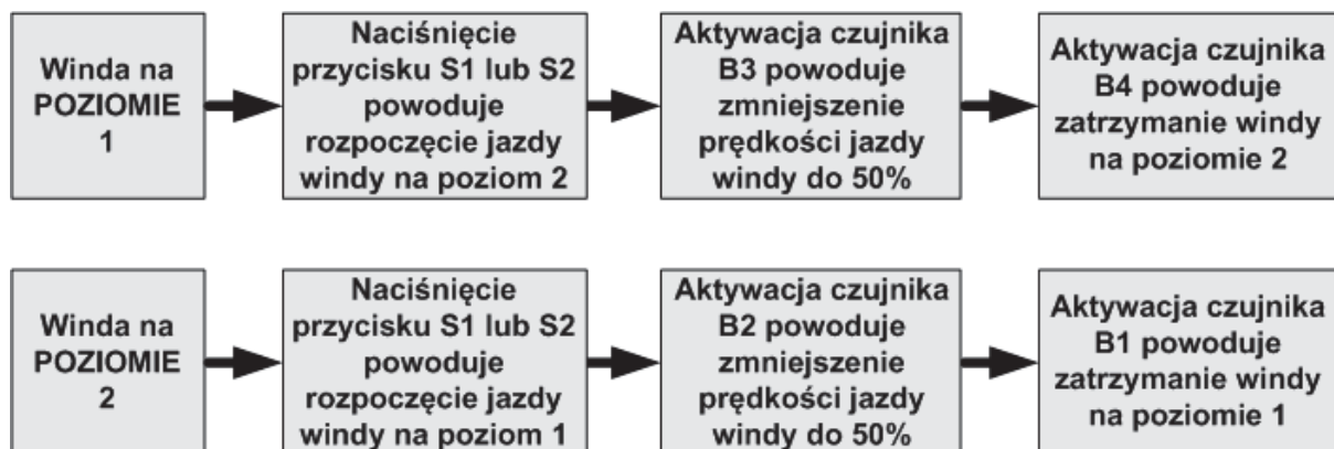
Rysunek 2. Diagramy działania programu sterowania windą
